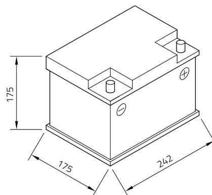
**Technologie** Geschlossene Kalzium-Batterie (Ca/Ca) | gefüllt und geladen | wartungsfrei
