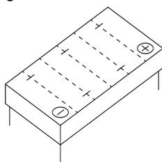
**Technologie** Geschlossene Kalzium-Batterie (Ca/Ca) | gefüllt und geladen | wartungsfrei
