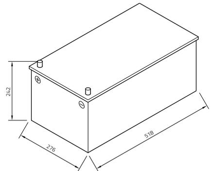
Technologie Geschlossene Kalzium- oder Hybrid-Batterie (Ca/Ca oder Sb/Ca)
